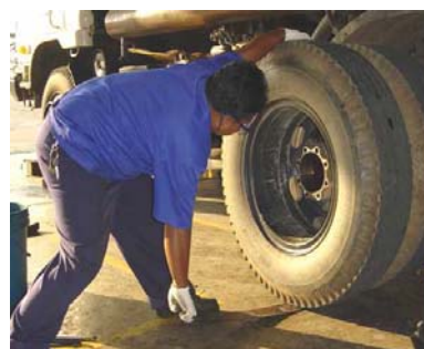
นำแผ่นเหล็กไปสอดใต้ล้อ เพื่อนำลอกออกจากเพลลา
