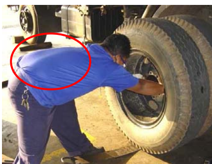
นำแผ่นเหล็กไปสอดใต้ล้อ เพื่อนำลอกออกจากเพลลา
