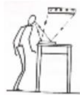
การติดตั้งแผงไฟเสริมที่มีขนาดใหญ่และมีหลอดไฟจำนวนมากอาจทำให้เกิดแสงสะท้อนเข้าตาได้
