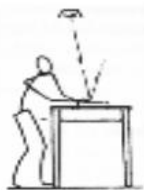
ตำแหน่งของไฟเสริมที่การติดตั้งทำให้ไม่มีแสงสะท้อนมารบกวนสายตา
