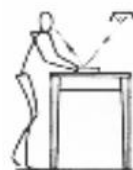
ตำแหน่งของไฟเสริมที่การติดตั้งทำให้เกิดแสงสะท้อนมารบกวนสายตา
