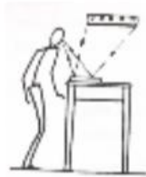
การติดตั้งแผงไฟเสริมที่มีขนาดใหญ่และมีหลอดไฟจำนวนมากอาจทำให้เกิดแสงสะท้อนเข้าตาได้
